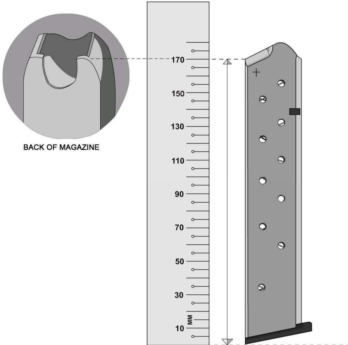
Il caricatore viene posizionato verticalmente su di una superficie piana, le misurazioni vengono prese dalla superficie piana alla parte posteriore delle labbra del caricatore, come illustrato. Sono consentiti solamente caricatori convenzionali, (caricatori flessibili, a tamburo, a "J", a "L", a "T" o di forma simile sono proibiti).
